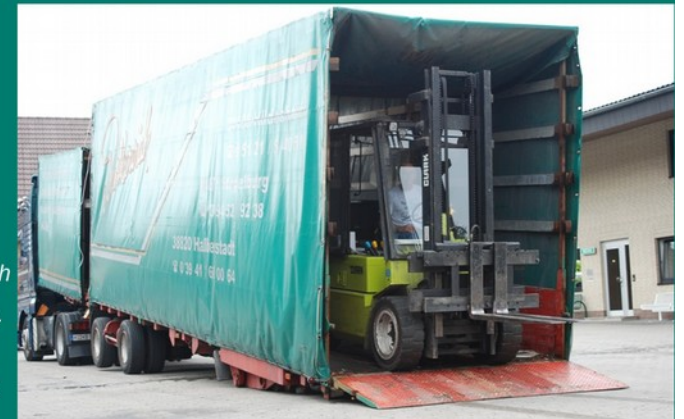
oder der Semi Tieflader (unter Plane) absenkbar bis auf die Erde
