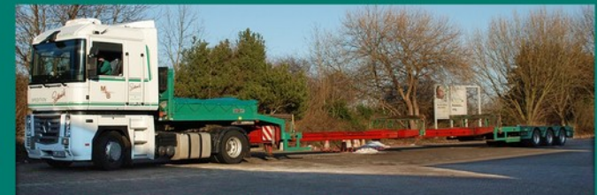
und der offene Semitiefelader mit Auffahrampen und Rungen - ist im Bett bis auf 21m ausziehbar.
