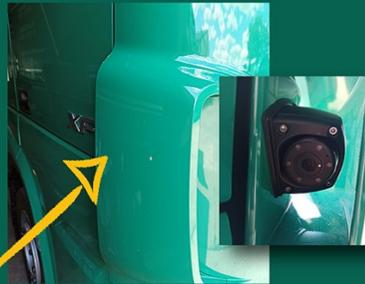
Diese kleine Kamera ist in der Verkleidung verbaut und liefert die Bilder direkt ins Fahrerhaus. Mittlerweile haben wir ein Viertel der Flotte damit ausgerüstet.
